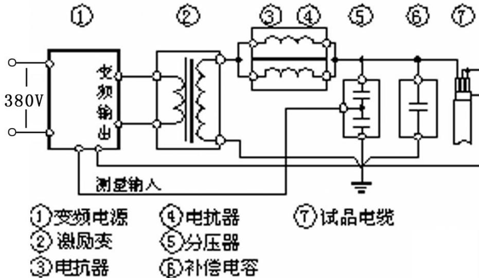
1、10kV 电缆  $300\text{mm}^2$  长度不大于 2km，试验电压为 21.75kV，试验频率为 30Hz~300Hz
