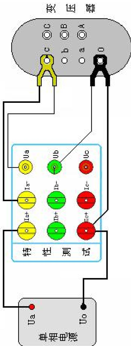
单相法变压器空载试验接线图
