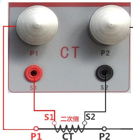
图 11 , CT 变比极性（角差比差）接线图
