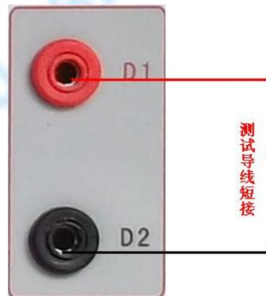
图 36, 导线阻值清零接线图
