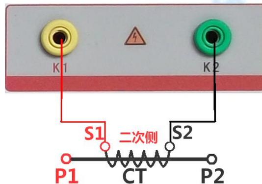
图 5, CT 励磁特性接线图
