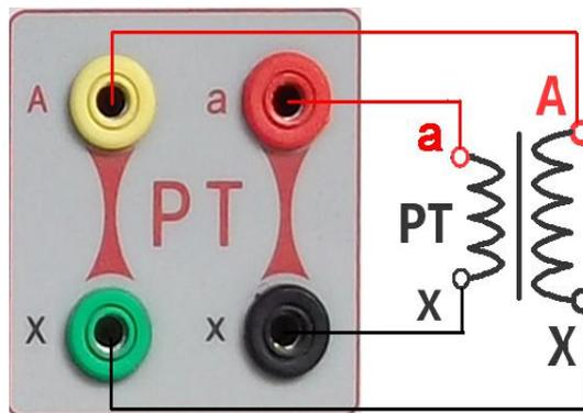
图 26, PT 变比极性测试界面
