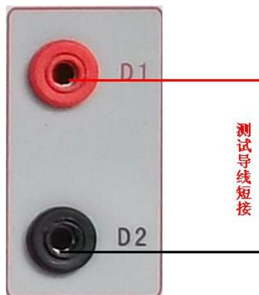
图 22, 导线阻值清零接线图
