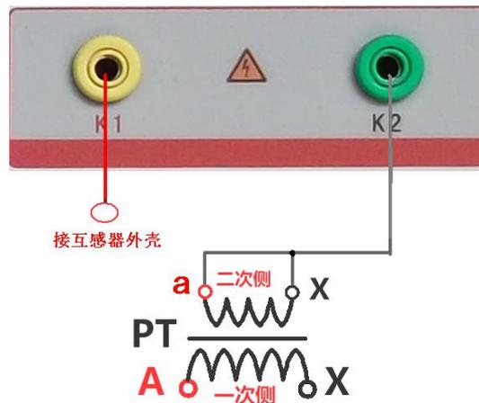
图 32, PT 交流耐压接线图
