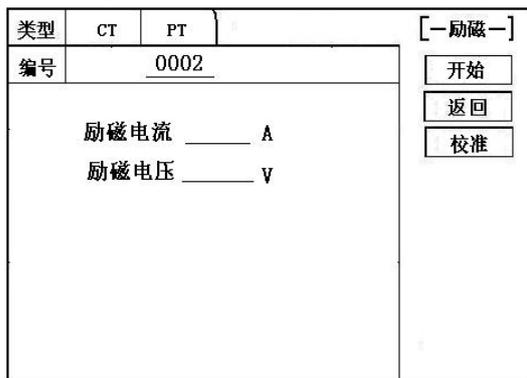
图 4, CT 励磁特性测试界面
