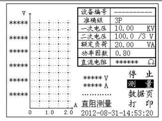
页面右下角显示"直阻测量"时,若光标移到"停止",则仪器只进行直流电阻的测量。若光标处于"测量",则仪器进行直流电阻以及伏安特性测量。
