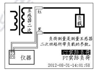
按照仪器显示的接线图,连接好仪器与被测线路。其中"红"、"黑"表示测试线的四芯线在被测线路的端子上红红短接,黑黑短接。
