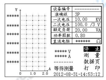
测量之前,请确保电压互感器的高压尾与大地良好接触! 测量之前,请确保操作人员与被试电压互感器于安全距离以外! 按"↑"、"↓"键,移动光标到"测量",进入伏安直阻测量:
