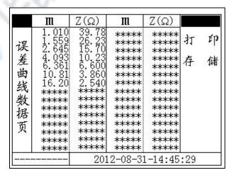
在"10.81"倍的保护倍数下,对应的阻抗为"3.860 $\Omega$ "。 远远大于额定负荷下的阻抗 30/(5\*5) = 1.2 $\Omega$ 。可以判定该保
