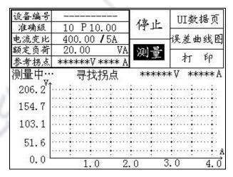
页面左上角为仪器测量进程显示,当不显示"等待测量"和"测量完成"时,表明仪器正在测量当中。在此过程中,请勿断开仪器和被测互感器的接线,以及切勿触摸被测互感器与测试夹!
