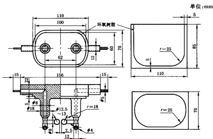
图1 试样杯和球形电极
