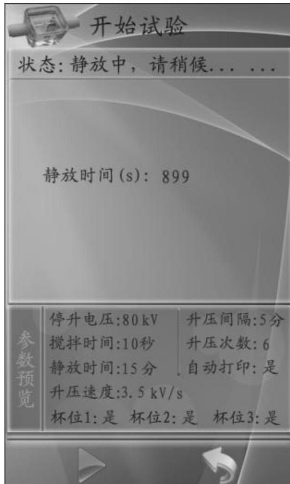
测试从 1 号杯开始，界面显示“静放中，请稍后……”、警方时间倒计时结束后显示依次显示“正在升压”“搅拌、降压以及延时……”，按顺序做完 3 个杯位，再重新从 1 号杯开始测试，直到完成用户设置的升压次数，蜂鸣器发出响声，按“返回”键返回初始界面。
