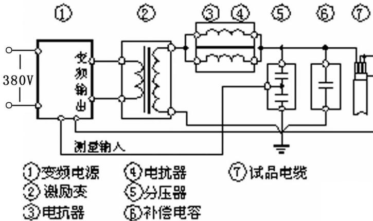
1、10kV 电缆 300mm<sup>2</sup> 长度不大于 3km，试验电压为 21.75kV，试验频率为 30Hz~300Hz
